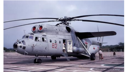
Mil Mi 6 Hook (rotor 5 pales diamètre 35 m)
