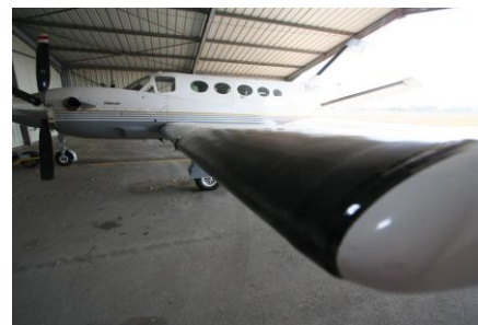
Boudins gonflables de bord d'attaque d'aile.
