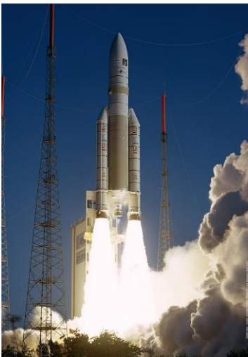
Ariane 5 et le Shuttle (Navette spatiale) combinent toutes deux des boosters à propergol solide et un moteur à propergol liquide.
