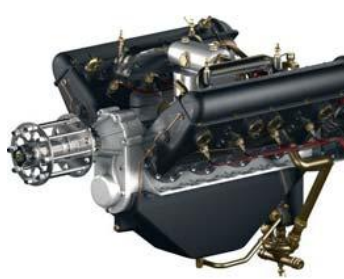
en V (8 cyl en V - Hispano Suiza du Spad VII)
