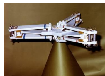
Tête de rotor "Starflex" (partie bleue clair sur l'image ci-contre) en composite (écureuils). Avec plateaux cycliques et vérins de commande.
