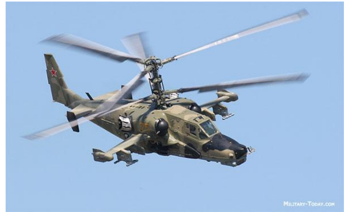
Les rotors contrarotatifs coaxiaux chez Kamov
