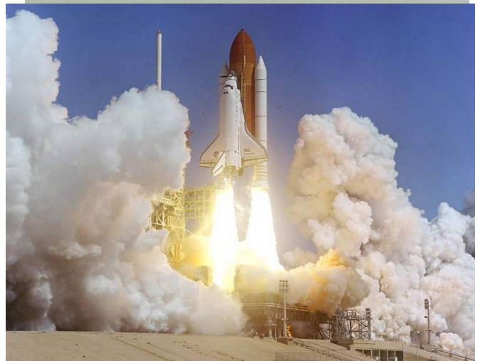
Ariane 5 et le Shuttle (Navette spatiale) combinent toutes deux des boosters à propergol solide et un moteur à propergol liquide.
