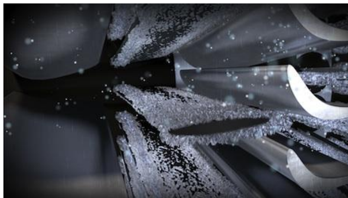
Givre dans un compresseur.
