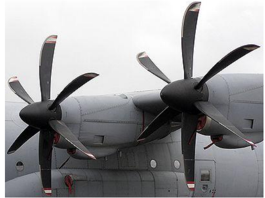
Les hélices de ce C130 peuvent se positionner en "reverse".
