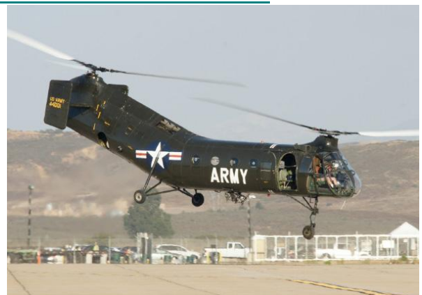
Les rotors en tandem du Piasecki H-21...dit "La banane"
