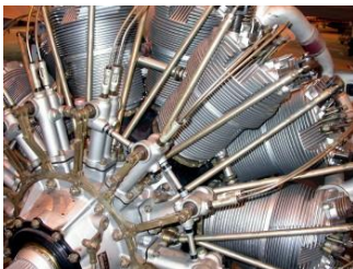
Ailettes de refroidissement d'un Clerget diesel en étoile avec double rangée de cylindres
