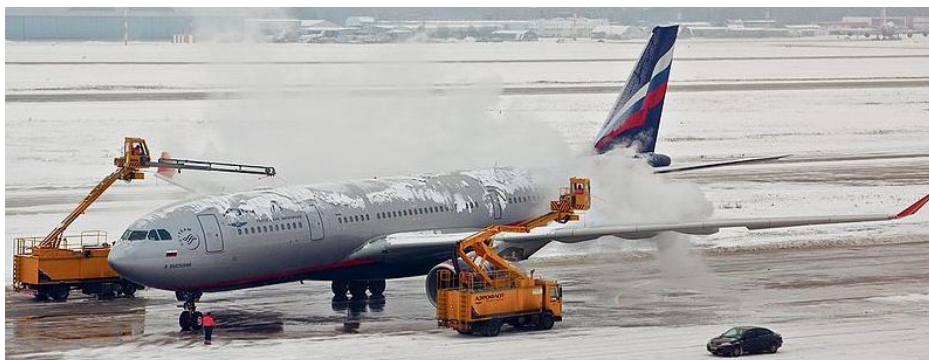
Dégivrage rapide suivi de la projection d'un anti-givre sur un aéroport ↑
