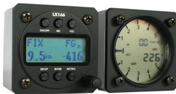
Le modèle LX 166 capable aussi d'afficher le plan de descente vers l'aérodrome de départ !
