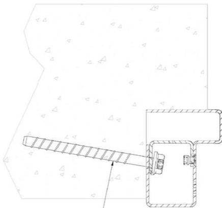
vis à béton vis FBS Ø8x100mm
