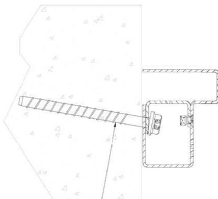
vis à béton vis FBS Ø8x100mm
